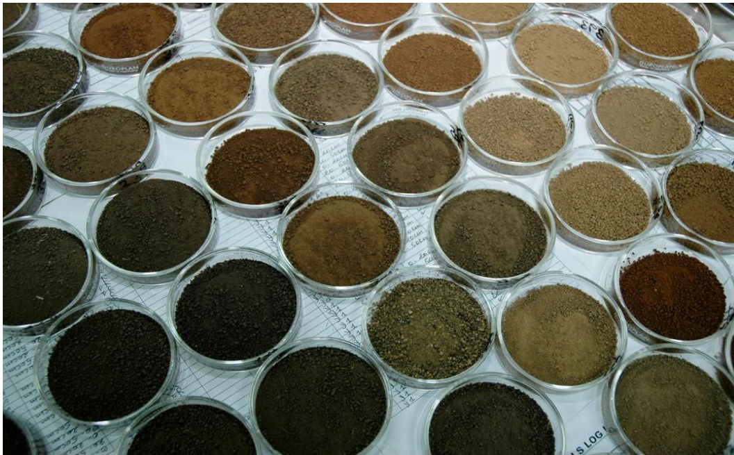
9. ábra. A talajminták vizsgálatra előkészítve a laborban
